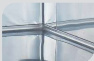
Fond de cuve avec angles arrondis : nettoyage simplifié, hygiène garantie
